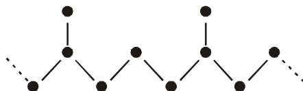
Hình IV.2: Cao su hydrogen hóa ( C_5H_{10} ) n (cơ cấu có lẽ đúng)
