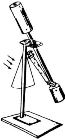
Hình V.6: con lắc Wiegand
